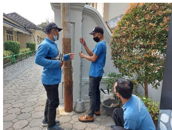
Pemasangan alat uji kualitas udara passive sampler mewakili sektor perkantoran.
