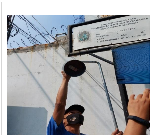
Pemasangan alat uji kualitas udara passive sampler mewakili sektor industri di Kelurahan Sorosutan.
